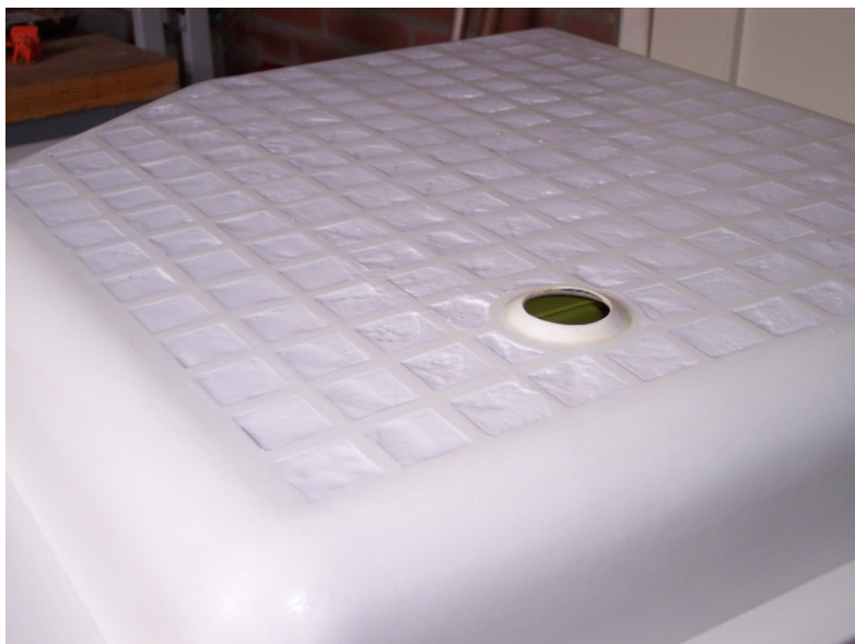
Eerste laag plamuur aangebracht in het wafelpatroon.
