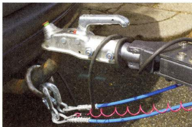
Dit is volgens de Amerikaanse ontwerper de veiligste en stevigste manier om de beide veiligheidskabels aan het trekkende voertuig bevestigen. De doorsnee van de zware ring is dusdanig dat hij niet meer over de kogel kan schuiven als beide karabijnhaken van de veiligheidsdagen eraan vast zitten.
